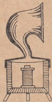
H. 98. Mặt cắt của loa điện từ có phần cổ ngỗng
